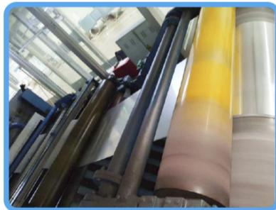
ANDEROL DDO é aplicado na folha de alumínio através do processo de lubrificação eletrostática, afim de garantir excelente uniformidade sobre a superfície a ser revestida.
