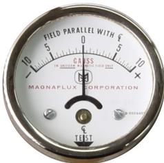
**29903301:** Medidor de campo magnético residual calibrado de 10 Gauss. Oferece medição altamente precisa de campos magnéticos residuais. Precisão de até 0,3 Gauss, com amplitude de escala de **-10 0 +10**. Acompanha certificado de calibração.
