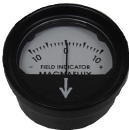
**29903201:** Robusto, indicado para uso do próprio operador, utilizado para indicar magnetismo residual.
